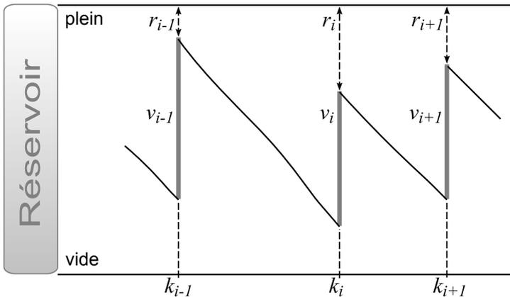
FIGURE 1: Niveau du réservoir en fonction du kilométrage
