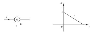
Un tel générateur est appelé un **générateur de tension** car il impose une tension u à ses bornes. Il est caractérisé par une **force électromotrice** e et une **résistance interne** r; en **convention générateur**, il délivre à ses bornes une tension u de la forme :
