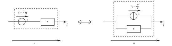
Un générateur réel est physiquement un générateur de tension. En effet, dans le modèle de Norton, le générateur isolé délivrerait un courant non nul, ce qui est impossible. En revanche, dans le modèle de Thévenin, le générateur isolé a une tension non nulle à ses bornes, ce qui est tout à fait possible. Le modèle de Norton est un outil purement théorique permettant la résolution facile de certains exercices.
