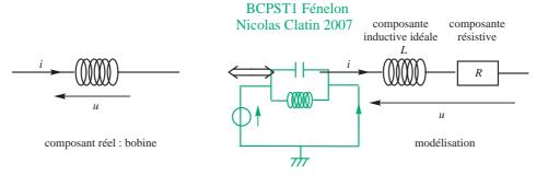
Il est fréquent de supposer les bobines idéales dans les circuits. En pratique, sauf précision explicite de l'énoncé, on néglige la composante résistive des bobines. Cependant, contrairement aux condensateurs, cette approximation est souvent assez grossière, car la composante résistive d'une bobine est souvent relativement importante, contrairement à celle des condensateurs.
