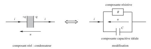
Il est cependant fréquent de supposer les condensateurs idéaux dans les circuits. En pratique, sauf précision explicite de l'énoncé, on néglige la composante résistive des condensateurs.
