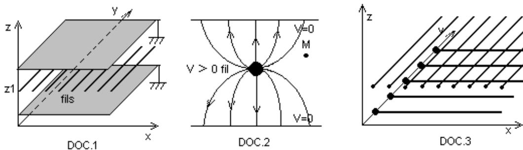
Entre deux plaques parallèles, est disposée une nappe de fils parallèles et équidistants (doc.1) Les fils sont portés à un potentiel de quelques kV et les plaques sont reliées à la terre dont le potentiel sert de référence.
